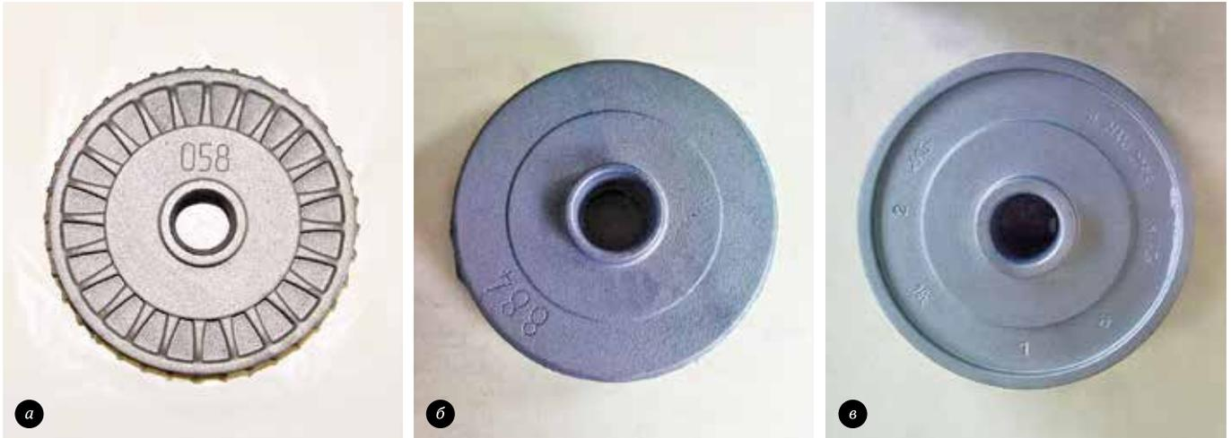
Рис. 1. Литые заготовки «Барабан тормозной» различных моделей
