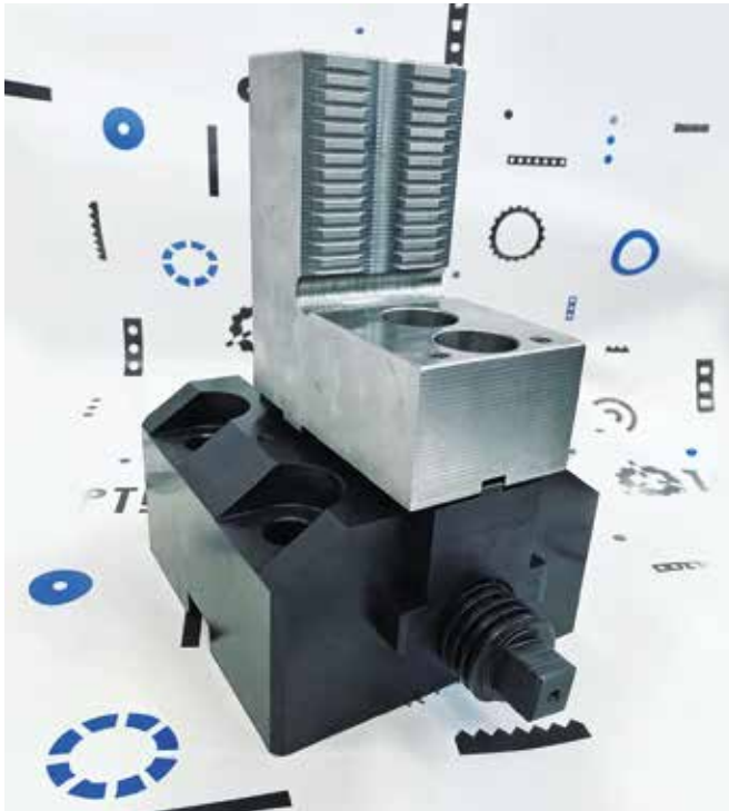
Рис. 5. Система «мастер-кулачок и кулачок»
