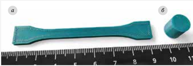
Рис. 1. Образцы на растяжение (а) и сжатие (б)
