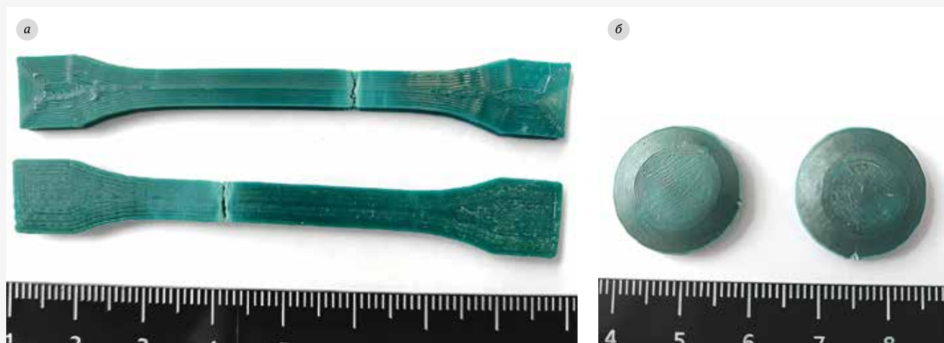
Рис. 5. Образцы из филамента PLA после испытаний на растяжение (а) и сжатие (б)
