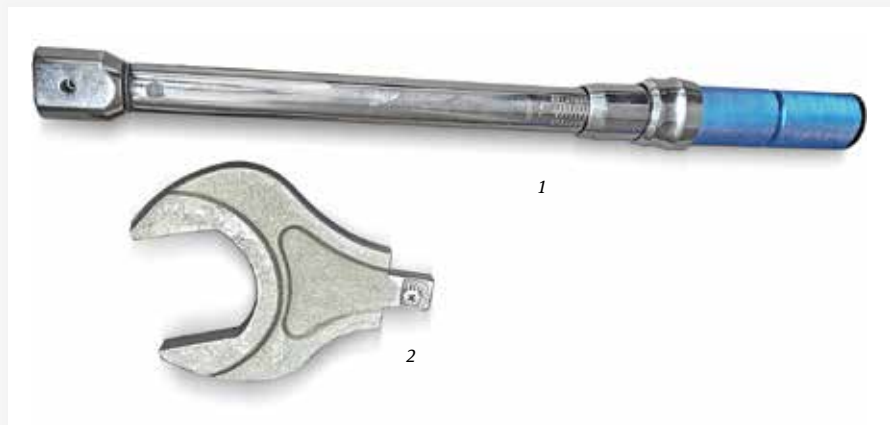
Рис. 3. Динамометрический ключ 1 с рожковой вставкой 2
