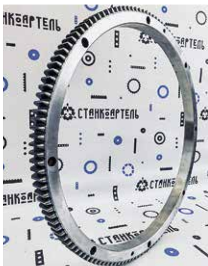
Венец зубчатый. Материал – сталь 40Х, рабочие поверхности по Н7
