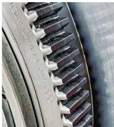
Венец зубчатый. Материал – сталь 40Х, рабочие поверхности по Н7
