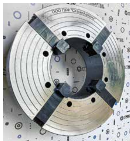
Патрон в сборе к трубонарезным станкам мод. 1Н983, СА983, СА984 (наружный диаметр 720 мм, внутренний – 340 мм), корпус – сталь 45, рабочие поверхности по Н7
