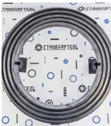
Диск спиральный (улитка). Материал – сталь 40Х, азотирование 48–52 HRCэ, рабочие поверхности по Н7, химическое оксидирование с промасливанием (далее Хим Окс Прм)
