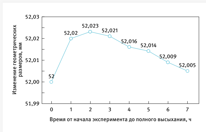
Рис. 7. Изменение геометрических размеров в интервале 7 ч до полного высыхания
