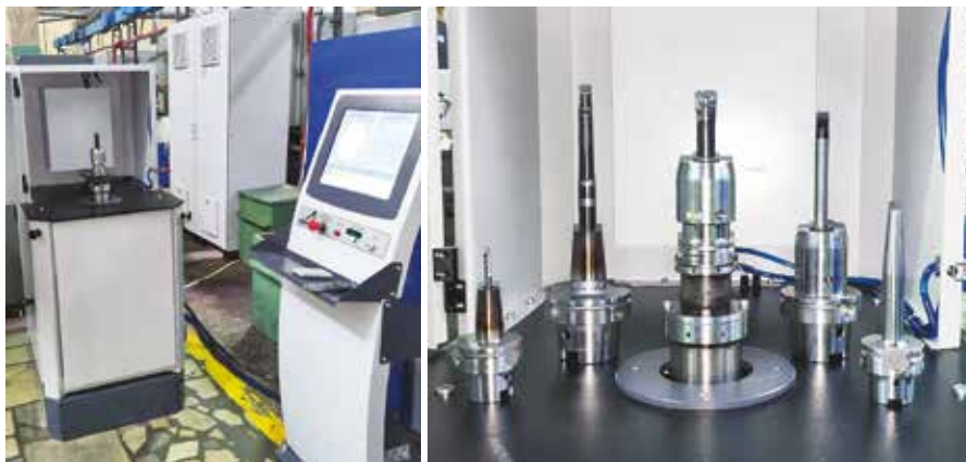
Вертикальный балансировочный станок В-20 для балансировки режущего инструмента
