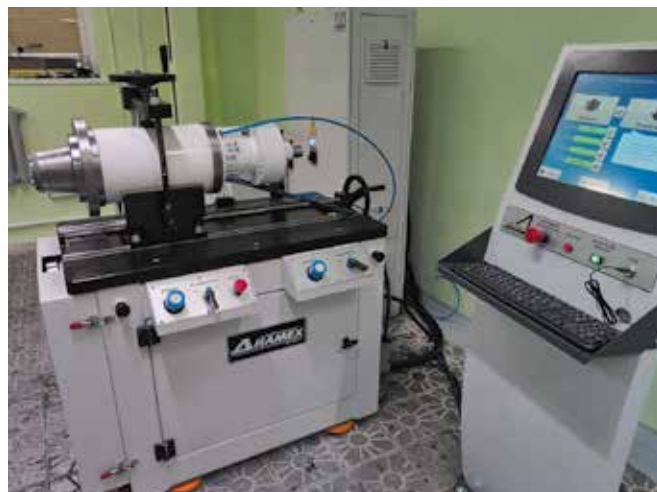
Стенд испытаний шпиндельных узлов СТШ-500
