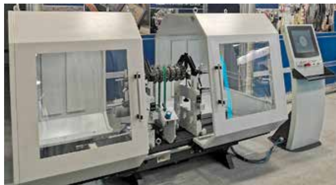
Горизонтальный балансировочный станок ВТ-100
