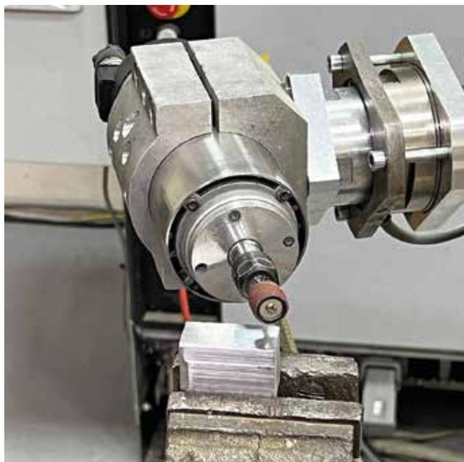
Рис. 4. Состав экспериментальной установки: промышленный робот ABB IRB 140, инструментальный шпиндель, силомоментный датчик FTN-AXIA80 SI-200-8 / SI-500-20
