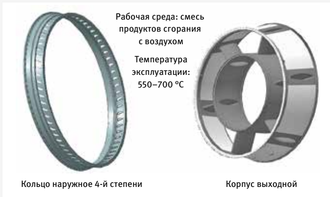
Рис. 2. Детали промышленной газотурбинной установки, получаемые методом ПЛВ
